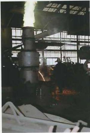
溶解炉から溶かした青銅をトリベに移す
