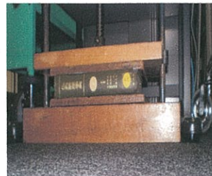
糊で貼り付けて固めるなどの補修を施す
