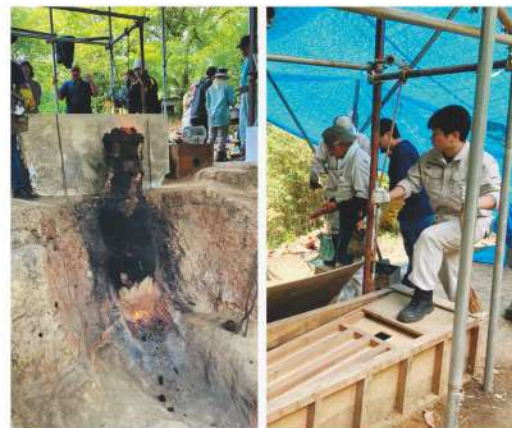
製鉄炉(左)とたたらを踏む横山さん
