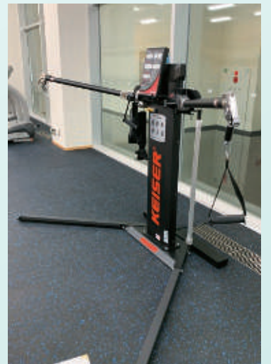
実際に使用する回旋動作などを数値化できるマシン
