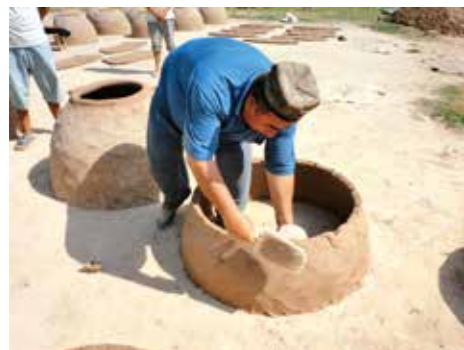
1 タンドール窯の基礎部分の製作 幅30cmほどの粘土板を丸くする。
