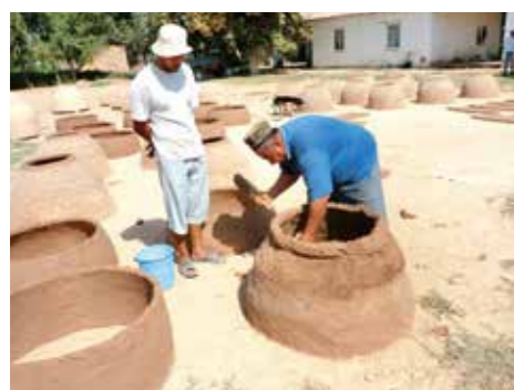
3 タンドール窯上部の製作 上をすぼめて円筒状に製作して口縁部を厚くする。
