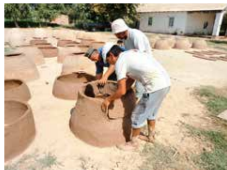
2 タンドール窯中段の製作 用具で叩き締めながら、基礎との接合を丁寧におこなう。
